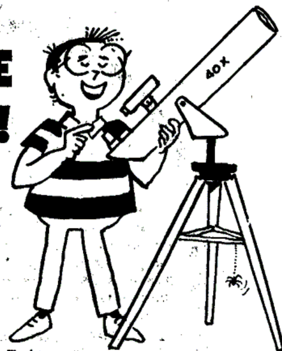
Telescopio refractor de 60 mm de objetivo y ocular de 20 mm (40 aumentos)
